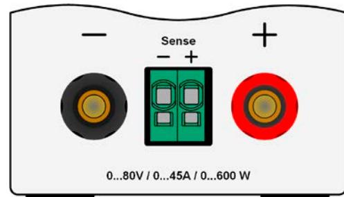
针对每条连接极输入线（多芯隔离线，末端垂悬）。单芯线如16 mm<sup>2</sup>，可用2x6 mm<sup>2</sup>的线代替。如果连线很长，需增大其横截面，以避免电压偏移和过热。
