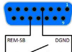
Rem-SB引脚可在远程控制模式下打开与关闭直流输入。它还可在非远程控制模式下工作。
