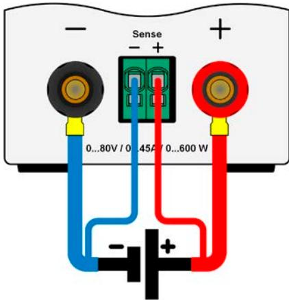
图 6 – 远程感测接线举例
