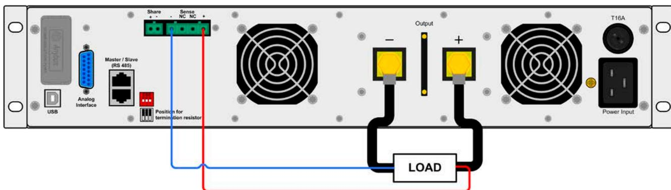
图 7 - 远程感测接线举例
