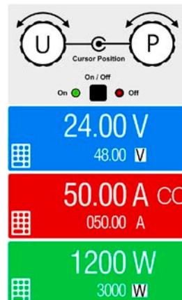
根据所选项，右旋钮可调节不同的设定值，左旋钮则通常用来调节电压。
