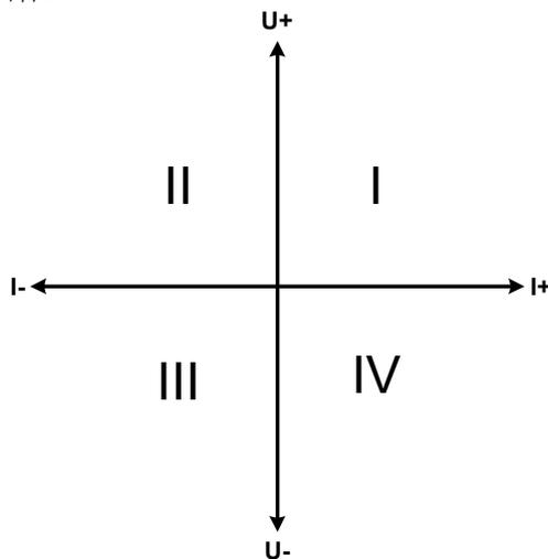
供电源与负载结合只能绘制I + II象限。意思是只能提供正向电压。正向电流由供电源或应用设备产生, 而负向电流则流向负载。
