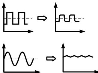
直流输出端形成的波形主要取决于所选波形的频率、幅度与产品上的输出电容。电源对波形的影响只有部分可补偿。配高速功能的修改版本，可以帮助减少上升与下降时间。它还对周期性函数，如方波或正弦波，具有积极的影响。增加额外的负载（固定&阻性，或可变&电子的）可以盖上直流输出端形成的波形。
