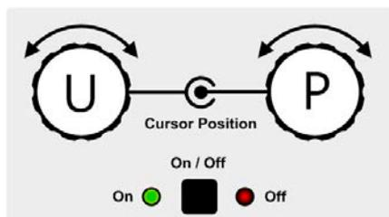
旋钮图释下的实物显示当前状态。对于电源产品，做旋钮总是用来调节电压U，按下该图释可转换到右旋钮。
