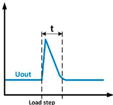
负载负向阶跃举例：直流输出值会在短时间内上升至调节值， $t$  = 输出电压稳定的变化时间。
