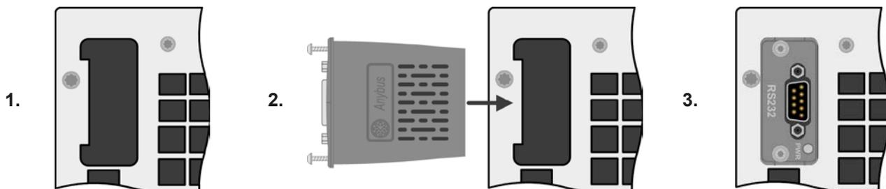
1. 用Torx 8螺丝刀取下插槽盖（备用模块）。
