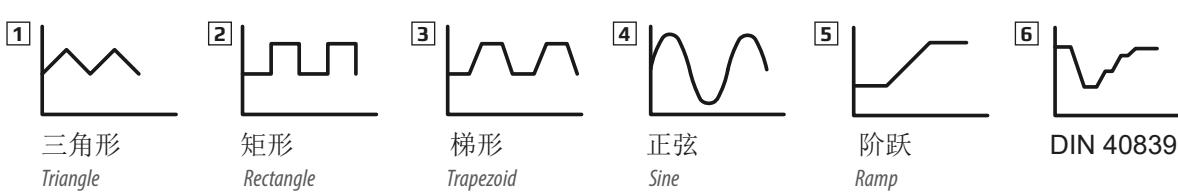
除了基于任意发生器产生的标准函数外，它还可形成某些复杂的函数，并能分成多达99组序列。这些可用于研发和生产的测试。通过前板的USB端口可将这些序列上载使用或存储于标准U盘上，这样可方便更换不同的测试序列。
